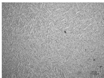
图1 TC4钛合金金相组织显微照片
